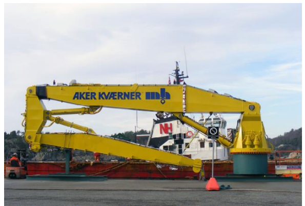
Suwnica obrotowa PDPH dostarczona przez Zamet Industry SA dla Aker MH
