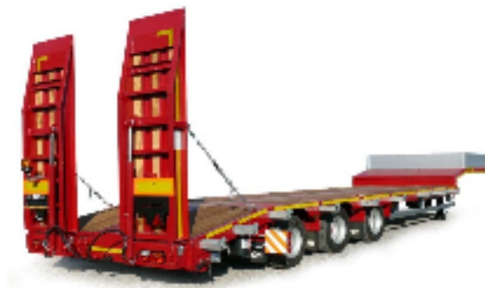
Opis: Naczepa niskopodwoziowa Jumbo 3-osiowa stała
