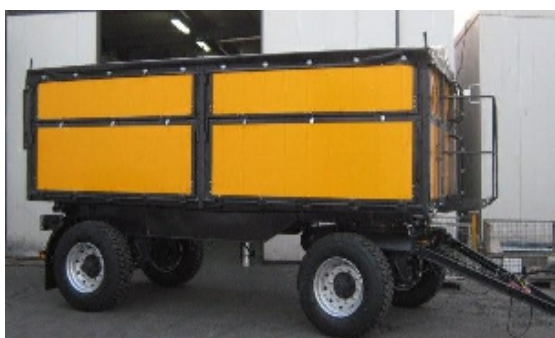
Opis: Przyczepa wywrotka z obrotnicą typu PRS-2/W14 burty aluminiowe
