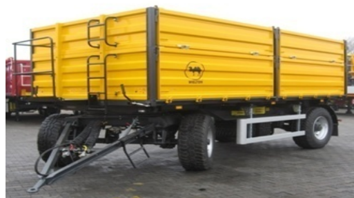
Opis: Przyczepa wywrotka z obrotnicą typu PRS-2/W14 burty stalowe
